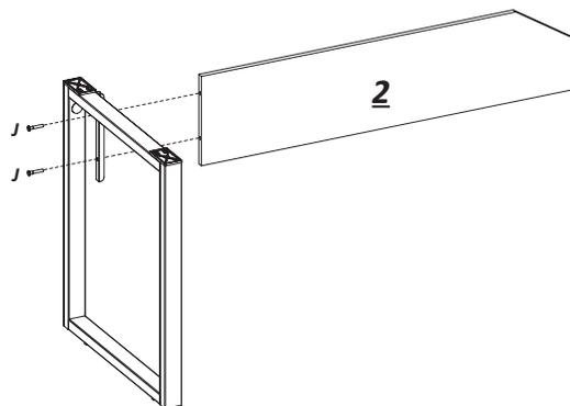
**2.2** Monte o pé ao painel frontal. Para fixar os parafusos utilize a chave allen de 4mm. Em seguida instale as tampinhas M na cabeça dos parafusos.
